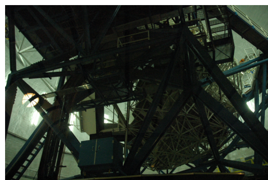
図2-5-12 ガラス越しに見るケック望遠鏡 架台の向こうに、主鏡セル部の巨大なトラス構造が見える。
