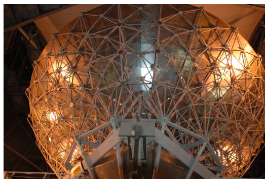
図2-5-15 JCMTの巨大な電波望遠鏡 ドームの中に、直径15mの巨大なサブミ リ波観測用電波望遠鏡がおさまっている。
